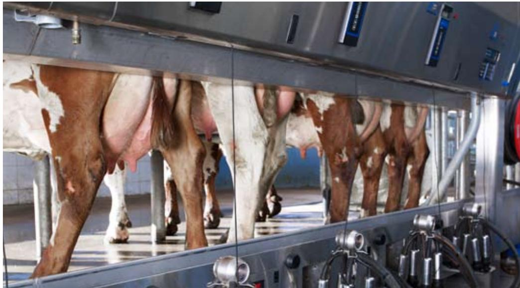
Les tuyaux à lait et à pulsation peuvent être acheminés depuis le dessous de la bordure de quai, les couppelles de lavage sont à la bonne hauteur, avec les coffrets d'éclairage permettant d'avoir une vue bien dégagée sur les postes.
